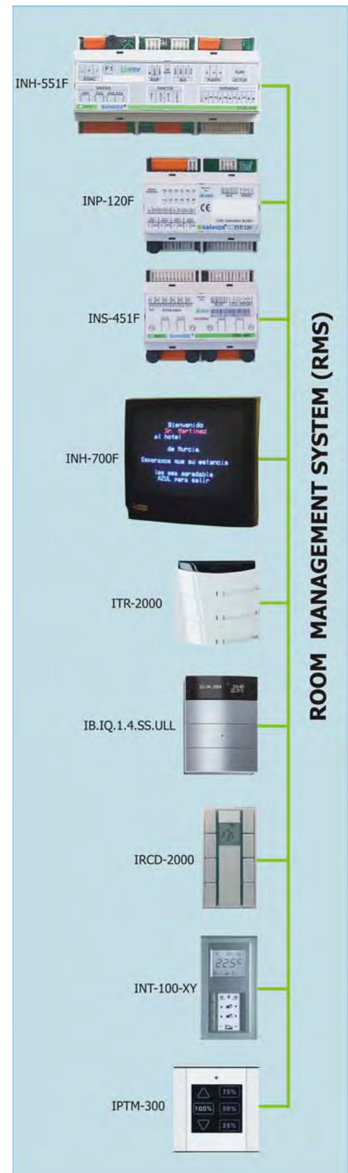
Figura 6. Esquema del subsistema RMS aplicado por la empresa ISDE.
