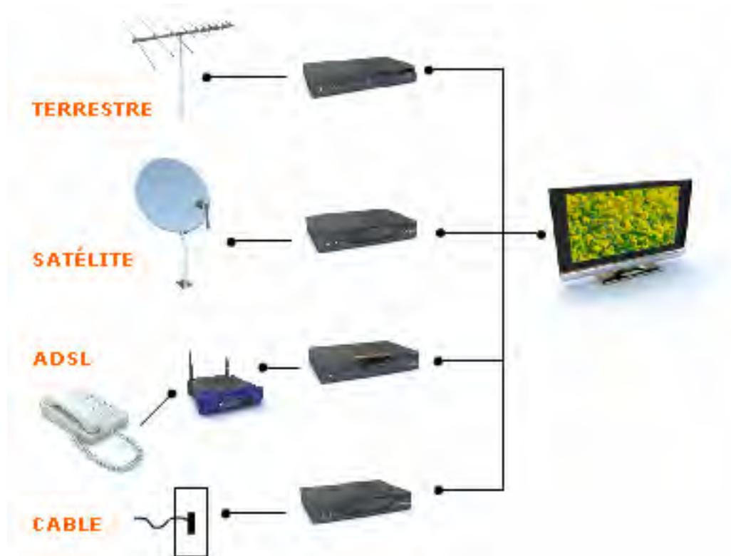
Figura 4. Esquemas para la recepción de televisión digital.
