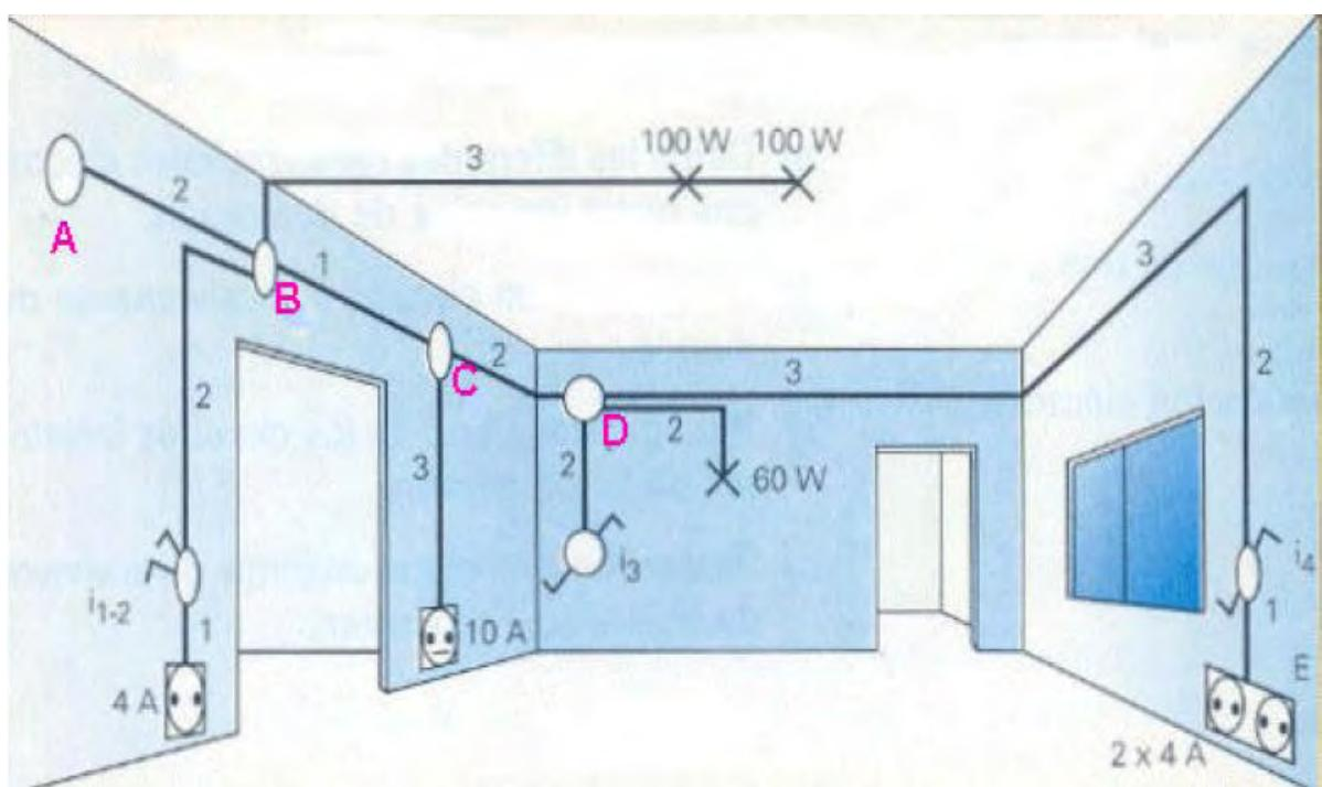
Figura 13. Instalación interior.
