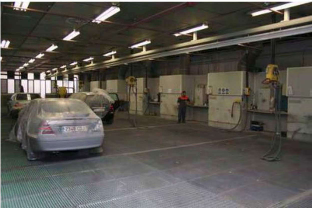
Figura 3. Detalle zona aspiración taller de chapa-pintura.
