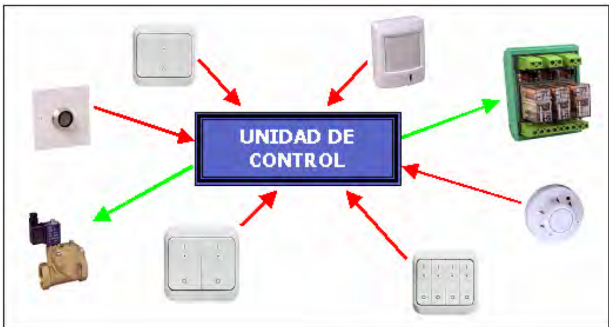
Figura 2. Configuración de un sistema domótico centralizado.
