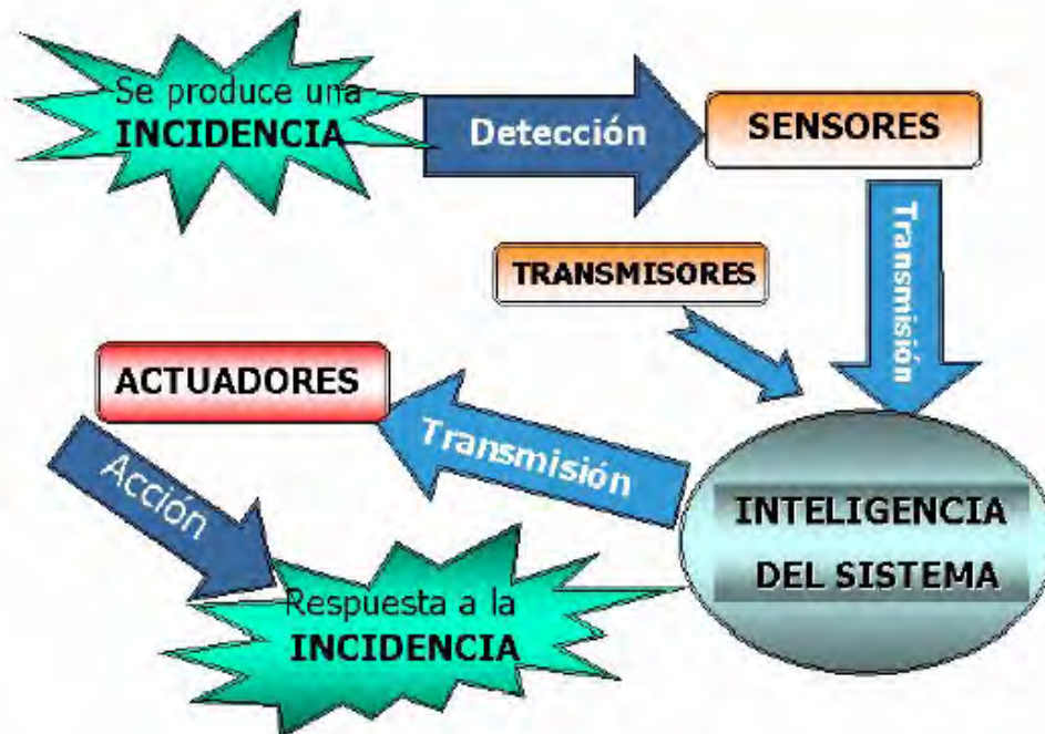
Figura 3. Esquema de actuación de un sistema domótico.
