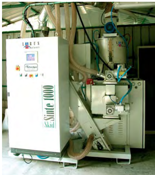
Peletizadora compacta con capacidad de producción de 100 kg/h. Consumo 0,13 kWh/kg de pelets.
