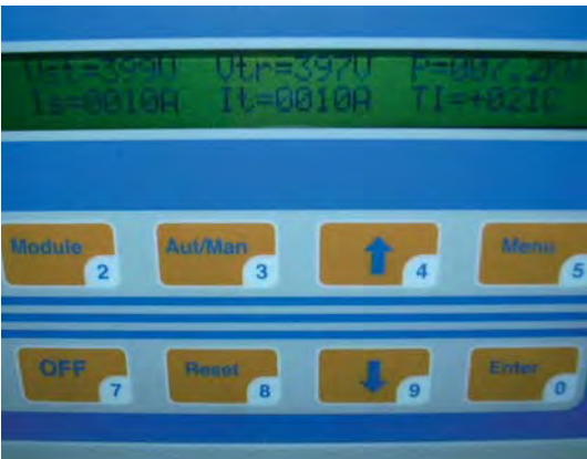
Display LCD con indicación de parámetros del inversor.
