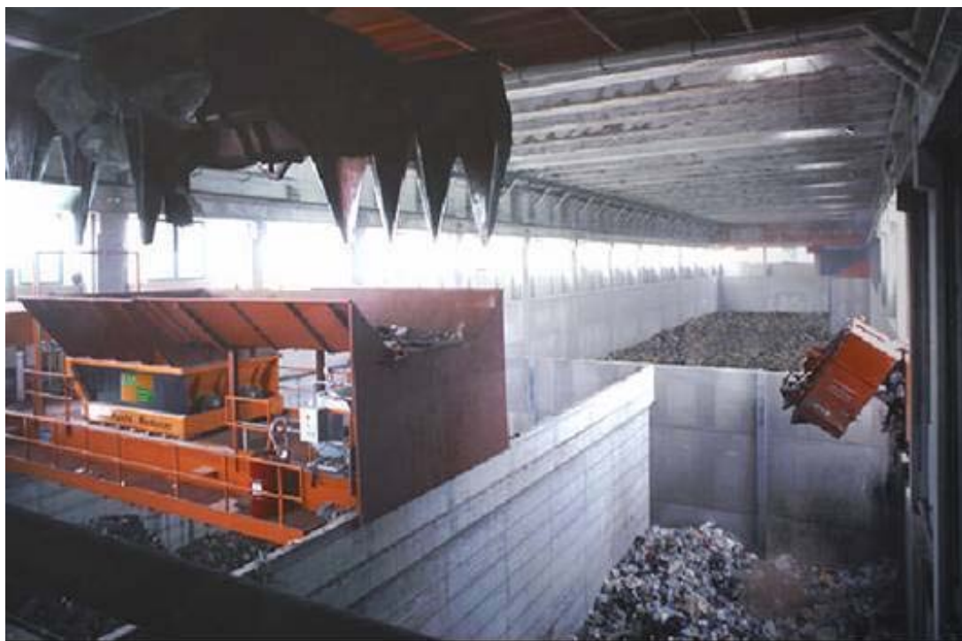
Foto 4. Vista del interior de una instalación de biosecado y producción de CDR. Triturador en primer plano. (Fuente: ECODECO).
