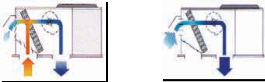
Figura 8. Entrada de aire de ventilación y utilización con enfriamiento gratuito.
