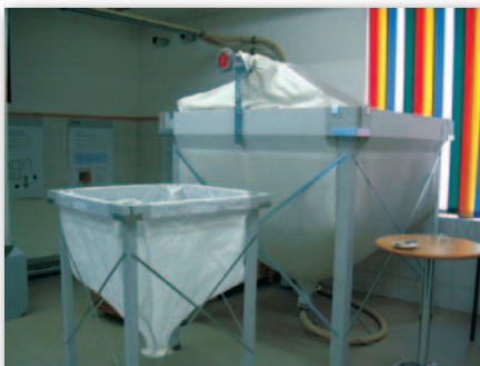
Figura 15: Silos de polipropileno para pellets (capacidad de 2 a 5 toneladas).
