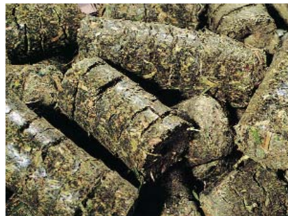
Productos de densificación: pellas y briquetas.
